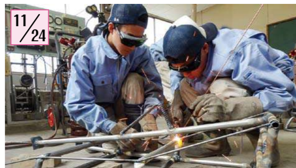
脚立製作で、協力して溶接作業を行う生徒(富士見高校より提供)
